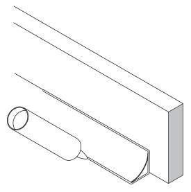
3) 突き合わせ(目地)部は隙間なくつないでください。 しかし、床の「なり」に合わせた場合、多少の隙間 ができることがあります。その場合、その隙間はシー ル材で埋めてください。
