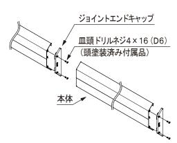
↑ 本体設置後にジョイントエンドキャップを取付けることはできないため、必ず本体設置前に行ってください。
