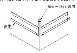
副体の V 溝に付属の鍋頭ドリルネジ 3.5×16を打ち込んで固定してください。
